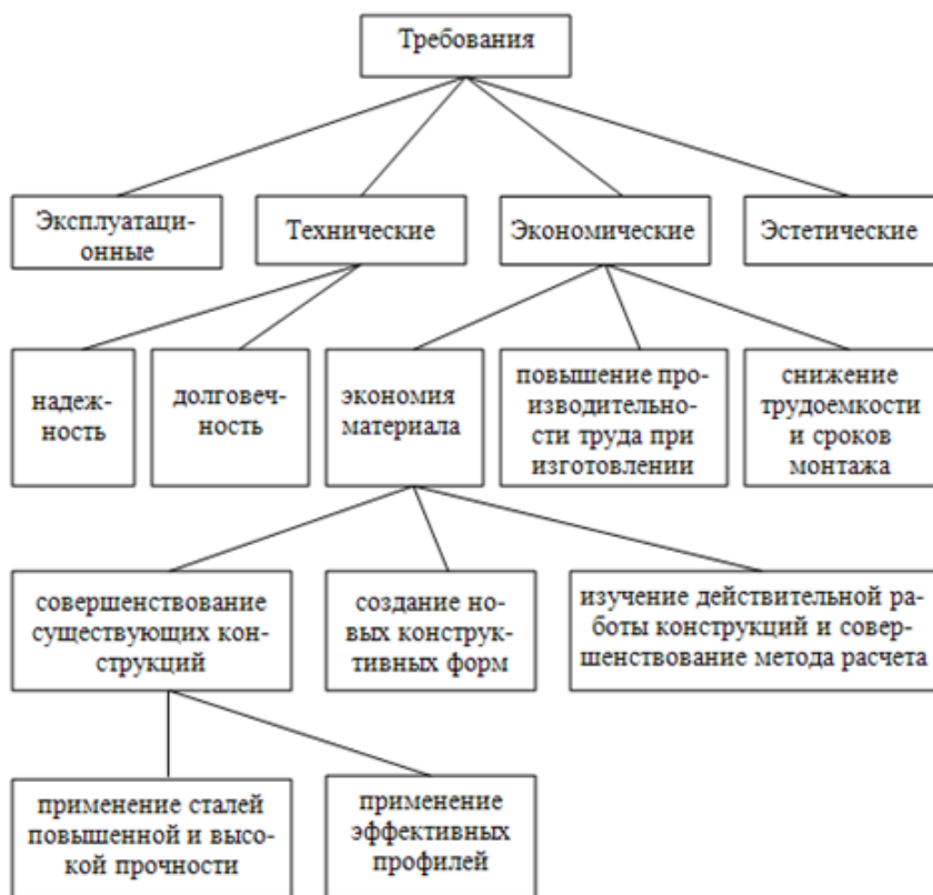
Рисунок 1.7 – Основные требования к металлическим конструкциям
