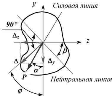
Рисунок 7.8 – Перемещение при косом изгибе
