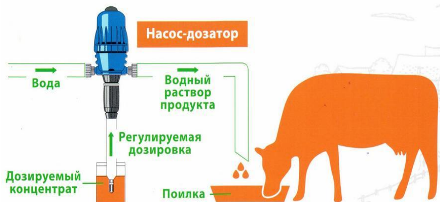
Рисунок 2 – Схема подачи ЖЭК коровам
