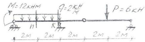
Определить поперечную силу в сечении «п» и изгибающий момент в сечении «к»
