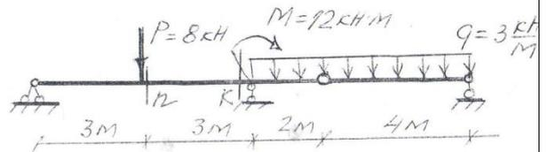
Определить поперечную силу в сечении «к» и изгибающий момент в сечении «п»
