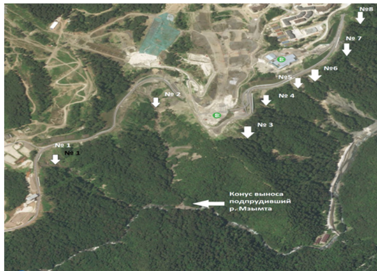
Рисунок 4. Схема селеопасных водотоков №№ 1–8, вынесенная на космический снимок территории «Роза Плато»
