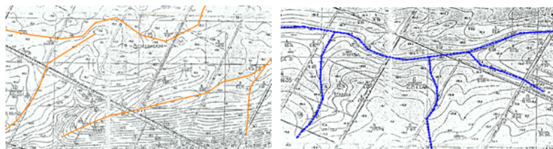
Рисунок 1. Пример нанесения на рельефной карте линий водоразделов и водотоков в программе AutoCAD
