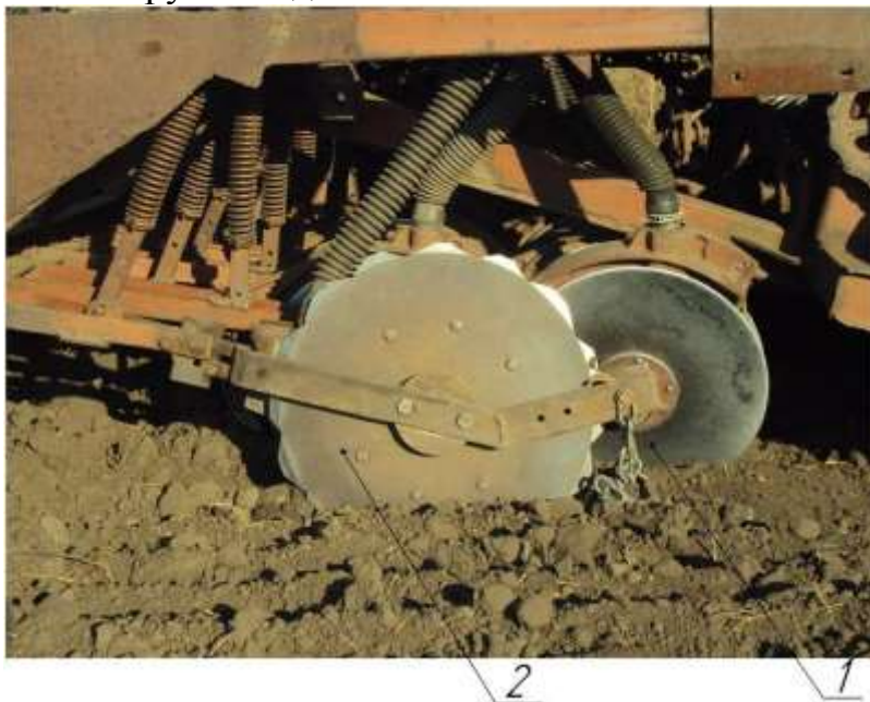
Рисунок 2 – Фрагмент посевного агрегата, оборудованного стандартным сошником 1 и комбинированным дисковым сошником 2
