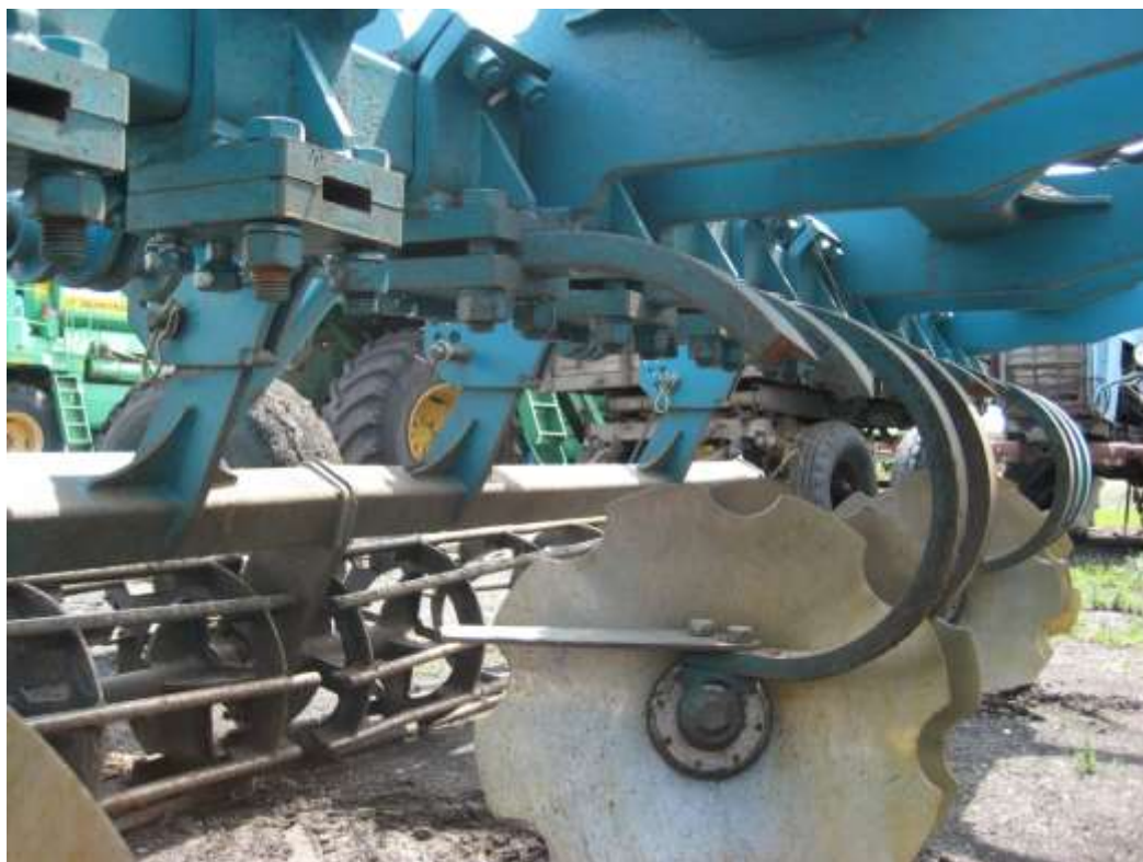
Рисунок 1 – Разрушение пружинных стоек дисков
