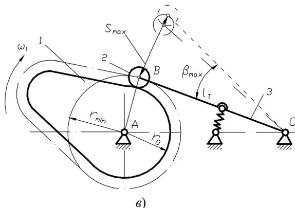
**Рис. 1. Кулачковые механизмы с силовым замыканием высшей пары**
