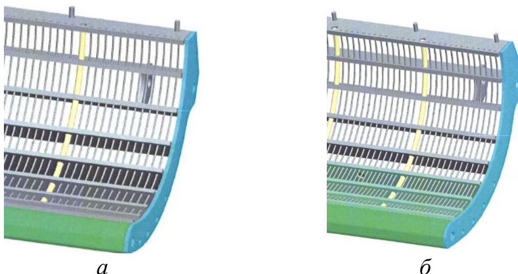
Рисунок 9.9 – Подбарабанье: а – старого типа; б – нового типа
