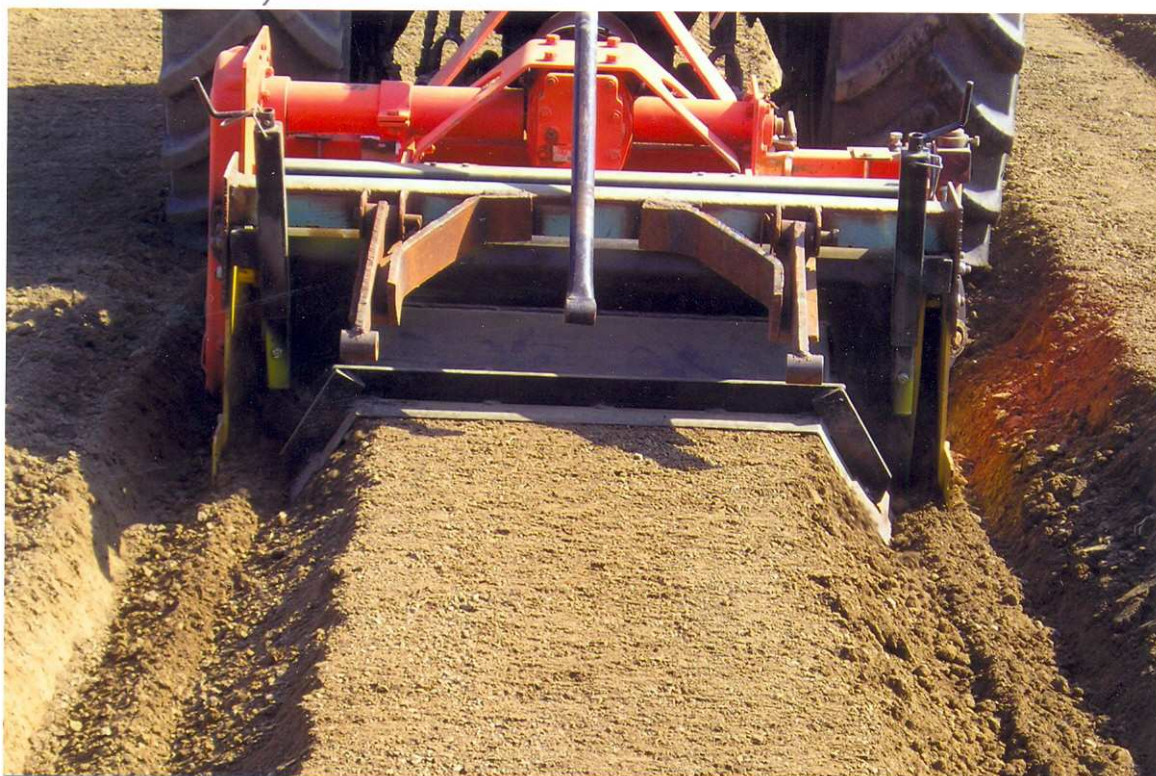
Рисунок 15. Формирование «гребня» для посадки рассады земляники
