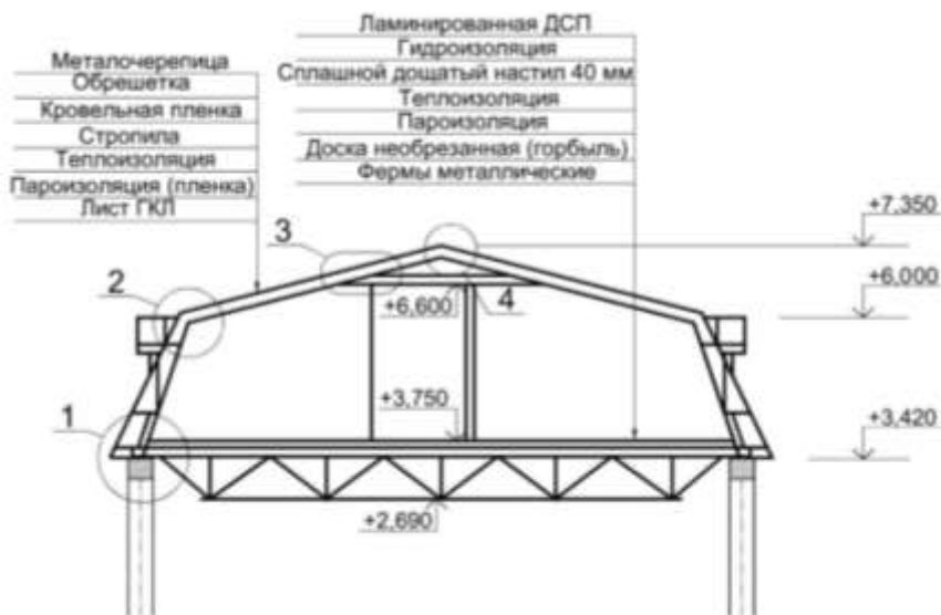
Рисунок 1.101 – Фрагмент реконструируемого здания при устройстве кровли из металлочерепицы
