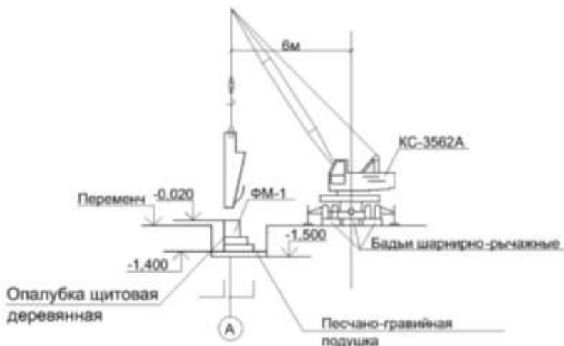
Рисунок 1.89 – Схема производства бетонных работ при устройстве столбчатых фундаментов
