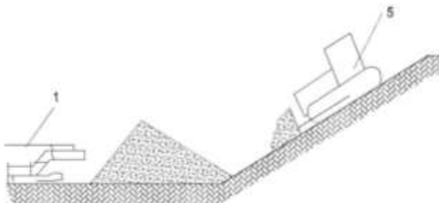
Рисунок 1.55 – Схема комбинированного способа разработки грунта:
