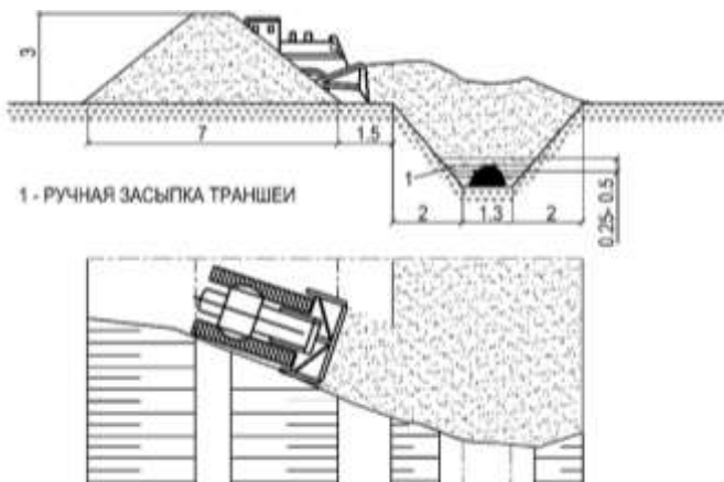
Рисунок 1.30 – Технологическая схема засыпки траншеи бульдозером
