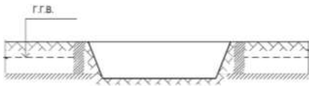
Рисунок 1.21 – Технологическая схема устройства ограждающего экрана из глины вокруг котлована
