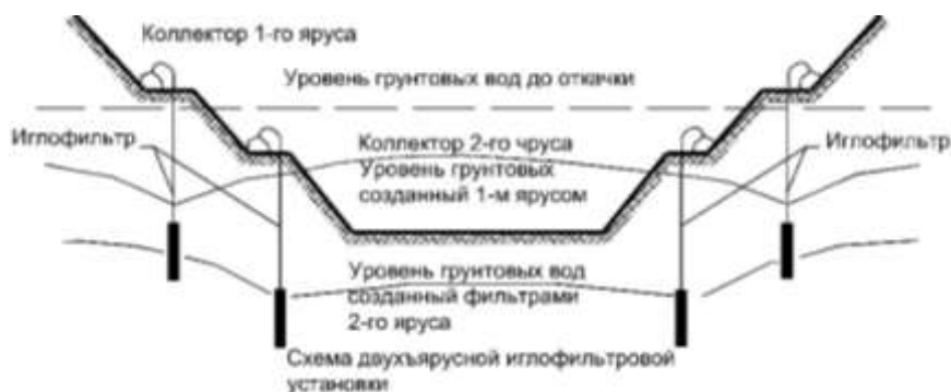
Рисунок 1.19 – Технологическая схема многоярусной водопонижительной системы
