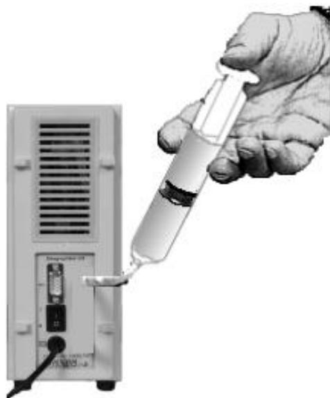
Рисунок 5 – Схема полной мойки анализатора
