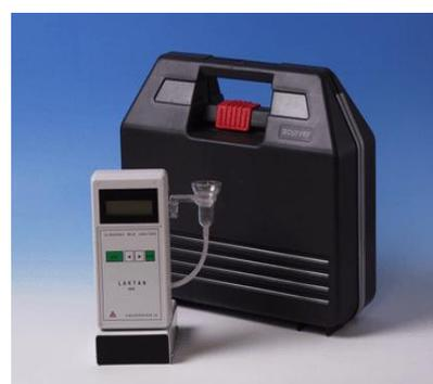
боты прибору необходимо прогреться. Прибор сделает это автоматически, и сам выдаст сообщение на дисплей о готовности к работе. На прогрев уйдет не более 5 минут. Необходимо только включить прибор в сеть. После прогрева можно работать с анализатором весь день.
