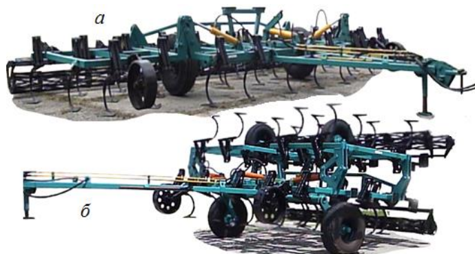
Рисунок 3 – Культиватор прицепной КППУ-8 в рабочем (а) и транспортном (б) положениях
