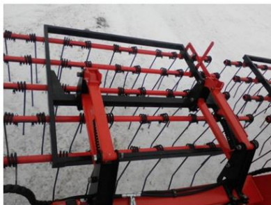
Рисунок 4 – Крепление секции на бороне пружинной «СоломМастер-21»
