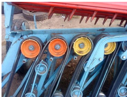
Рисунок 1 – Инновационный тербильный аппарат льнокомбайна ЛК-4А
