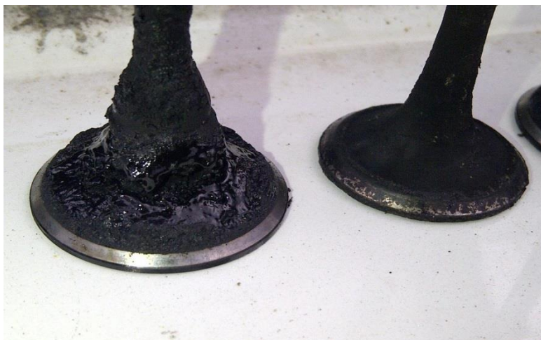
Рисунок 3 – Нагар на впускном клапане при непосредственном впрыске бензина в цилиндр
