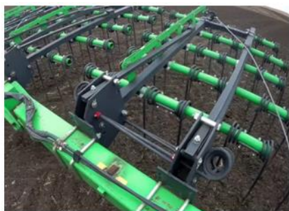
Рисунок 2 – Крепление секции на бороне пружинной БПГ-24.3
