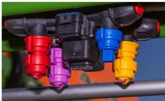
Рисунок 3 – Система включения форсунок AmaSelect
