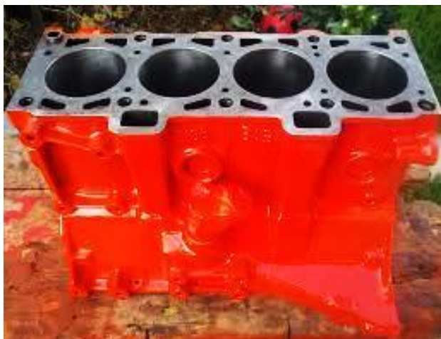
Рисунок 1 – Блок двигателя автомобиля с закрытой водяной рубашкой
