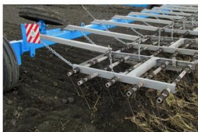
Рисунок 1 – Крепление секции на бороне пружинной БПГ-24
