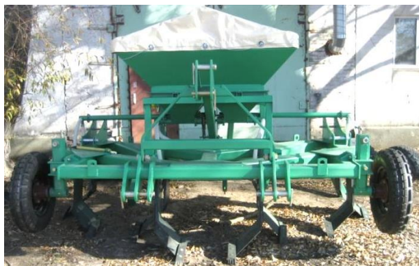
Рисунок 2 – Приспособление ПВУ с влагосберегающим рыхлителем РВН-4
