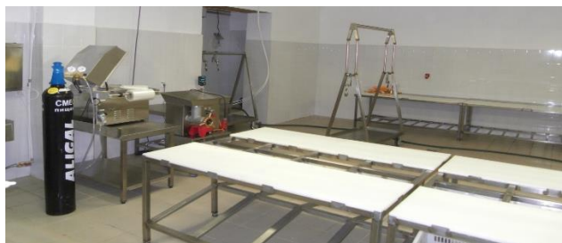
Рисунок 1 – Общий вид мясного цеха в К(ф)Х «Москвин А.А.» (тележки с крюками для четвертин, жиловочные столы, вакуумная машина, мясорубка).
