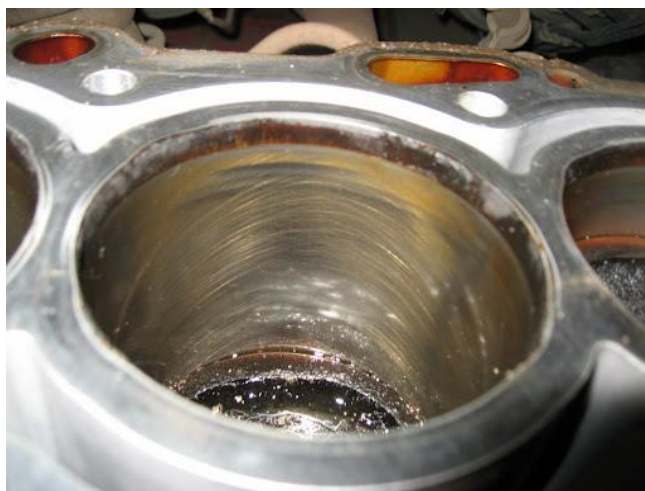
Рисунок 3 – Алюминиевый цилиндр с характерными пятнами от потери геометрии
