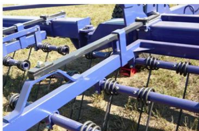
Рисунок 3 – Крепление секции на бороне пружинной БЗГТ-8 «ПОБЕДА»
