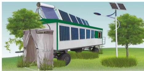
Рисунок 3 – Передвижной вагон с солнечной системой обеспечения жизнедеятельности обслуживающего персонала
