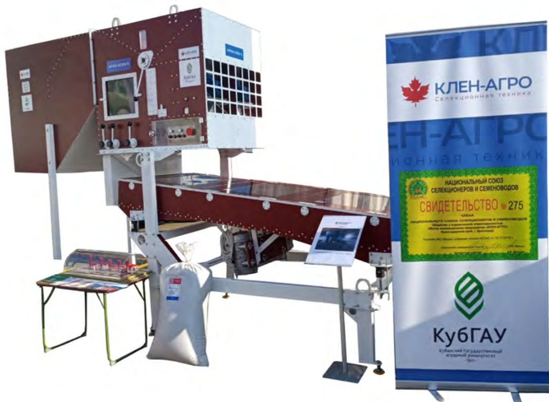
Рисунок 1 – Аэродинамическая зерноочистительная решетчатая машина (АРЗМ)
