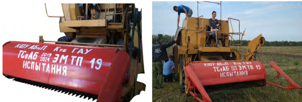
Рисунок 1 – Зерноуборочный комбайн с жаткой очесывающего типа
