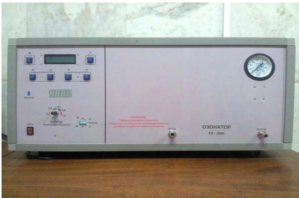
Рисунок 1 – Озонатор для профилактики и лечения бактериозов пчел
